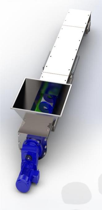
Le coclee di trasporto del tipo senza albero centrale consentono di trasportare prodotti a notevoli distanze con basse potenze e manutenzione ridotta al minimo.
